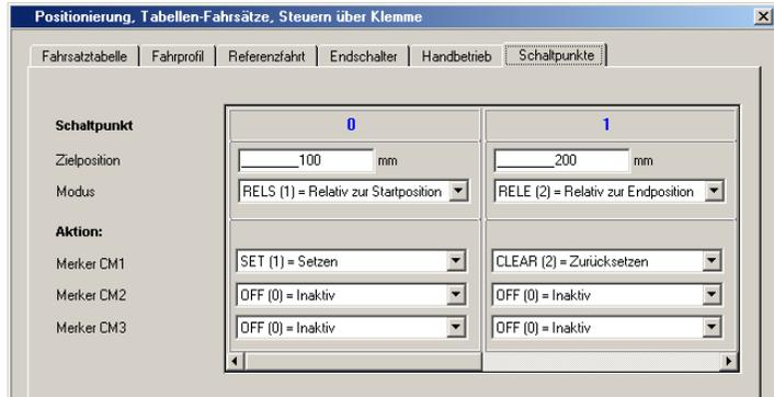
Bild 5.20 Auswahlfenster - Schaltpunkte
