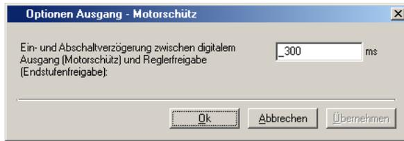
Bild 6.10 Einstellung der Abschaltverzögerung TENMO
