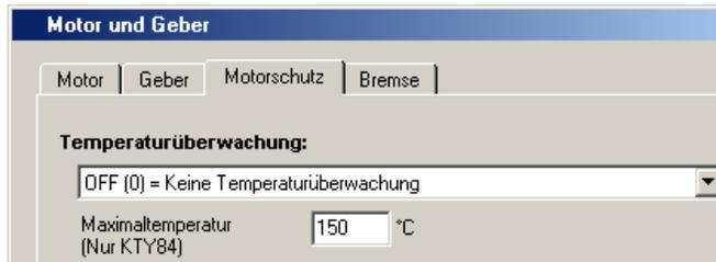
Bild 6.49 Überwachung der Motortemperatur durch Temperaturfühler bzw. temperaturabhängige Schalter.
