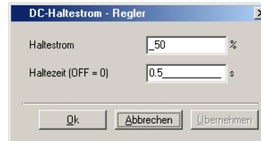
Bild 8.10 Funktionsmaske DC-Haltestrom-Regler
