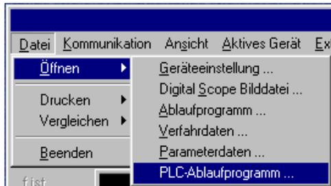
Bild 7.3 Öffnen eines PLC-Programms über den DriveManager
