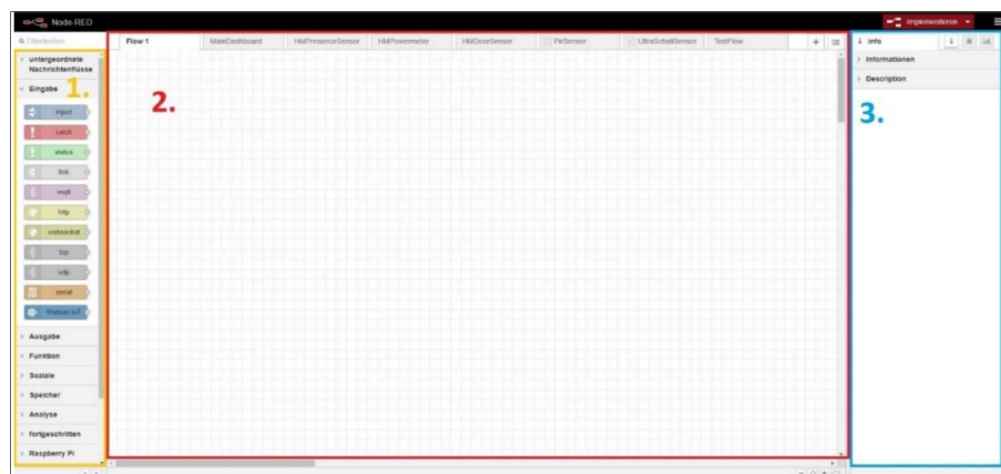
Abbildung 2: Aufbau der Entwicklungsoberfläche in Node-RED
