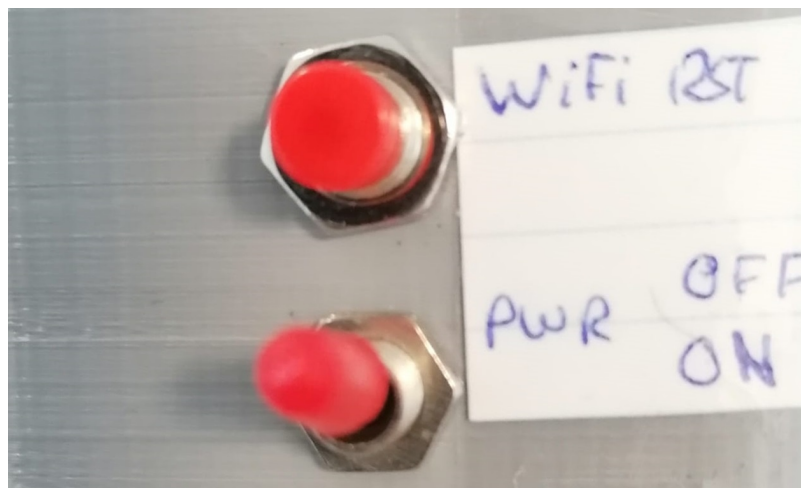
Abbildung 4.3.: Schalteschalter und Taster auf der Unterseite des Gehäuses
